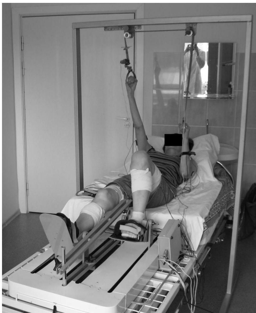
Рисунок 1. Экспериментальная установка для изучения взаимных влияний верхних и нижних конечностей при их совместных движениях.
