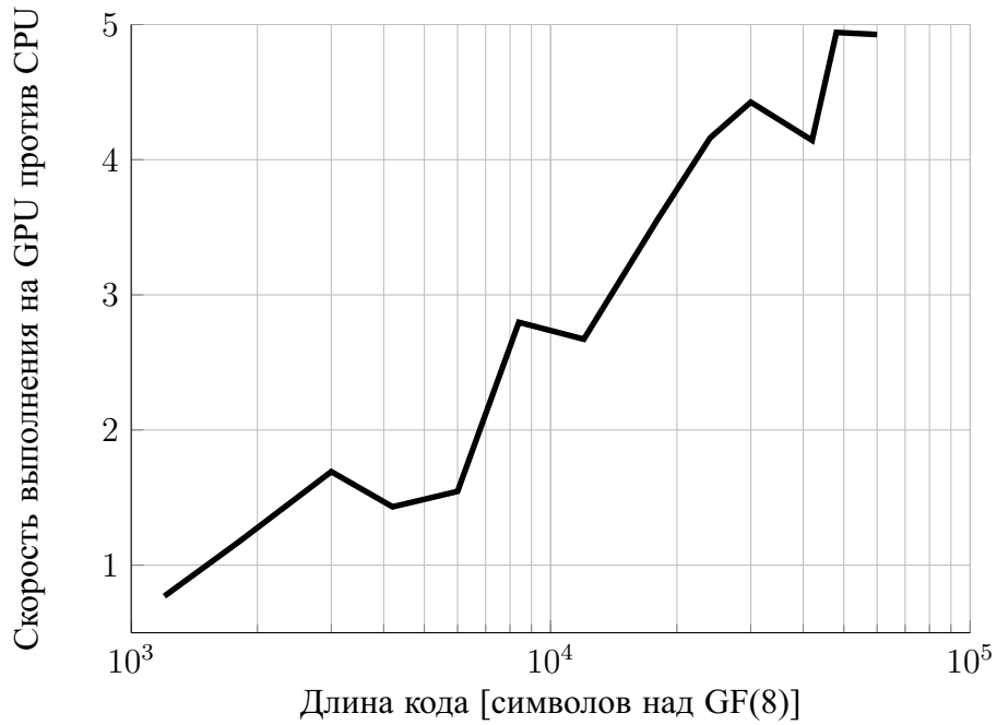
Рисунок 1.9. Отношение времени декодирования на процессоре ко времени декодирования на графическом ускорителе в зависимости от длины кода с параметрами: l = 3 , n_0 = 6 , R = 0.5
