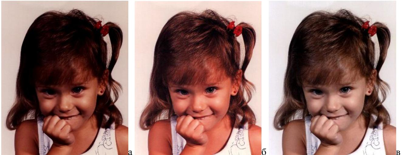
Рис. 3.4.1. Выравнивание функции локальных контрастов цветного изображения алгоритмом (3.2.12): а) исходное изображение; б) выравнивание по каналу яркости в **BHS** представлении; в) независимое выравнивание по каждому из цветовых каналов **RGB**.
