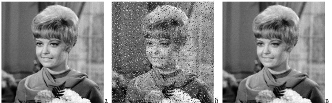
Рис. 3.1.4. Фильтрация изображения с импульсными помехами: а) исходное изображение; б) изображение с нанесенной импульсной помехой ( $p = 0,20$ ); в) обработка алгоритмом (3.1.18) с 3 итерациями, СКО от оригинала  $\sigma = 2,6$  градации.
