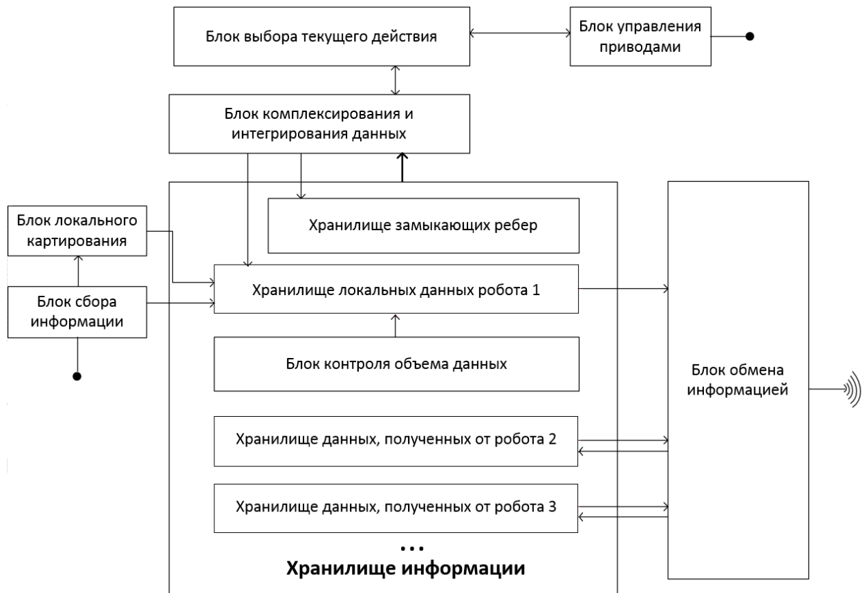
Рисунок 2.1. Структурная схема функционирования робота для решения задачи коллективного исследования
