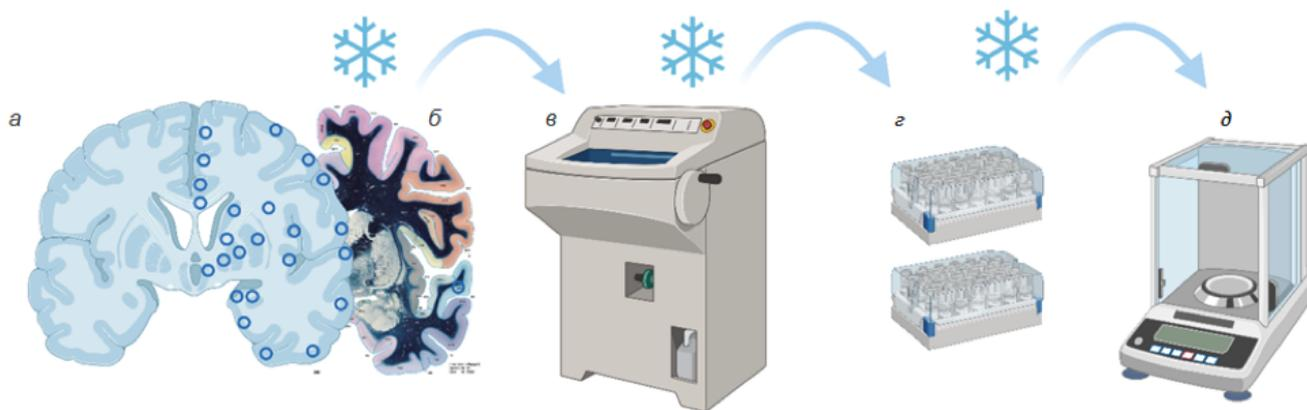
Рисунок 2.17 — Схема пробоподготовки образцов мозга для масс-спектрометрического анализа липидов: замороженные блоки мозга (*a*), выбор участков для вырезки образцов в соответствии с атласом мозга (*б*), выдерживание в криомикротоме при температуре  $-15\text{ }^{\circ}\text{C}$  (*в*), вырезка образцов (*г*), взвешивание (*д*). Адаптировано из [167].
