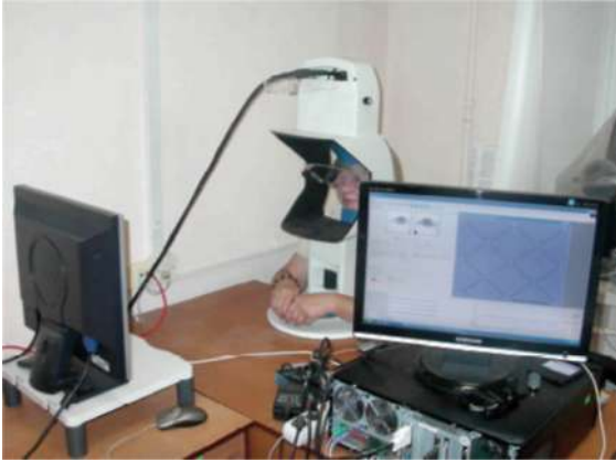
Рис. 6. Общий вид экспериментальной установки с испытуемым и двумя дисплеями - для стимуляции и контроля записи движений глаз.
