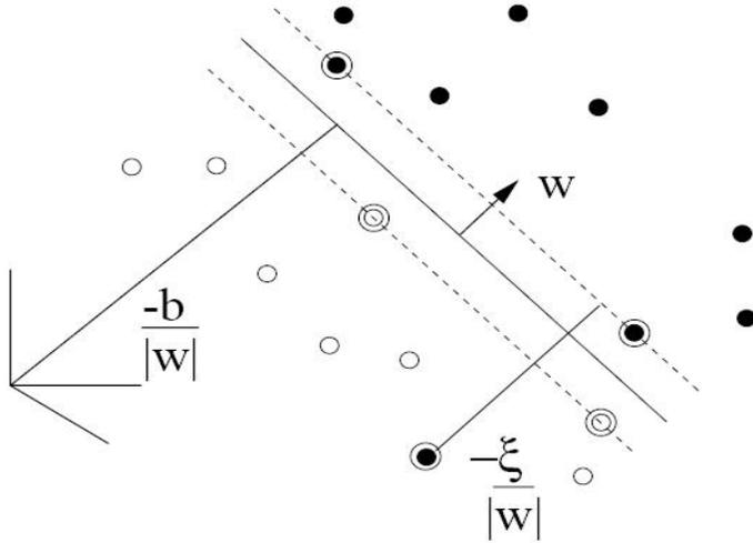
Рис. 1.2. Опорные векторы расположены на граничных гиперплоскостях или же неправильно ими классифицируются
