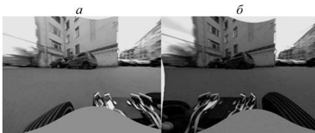
Рис. 6. Пример рассогласования яркости изображений с левой (а) и правой (б) камер.
