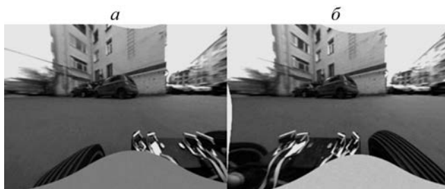
Рис. 7. Пример программной компенсации рассогласования яркости изображений с левой (а) и правой (б) камеры.
