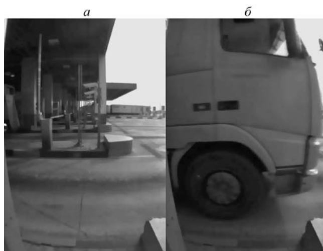
Рис. 4. Пример изменения яркости сцены, анализируемой АКТС, в результате появления распознаваемого объекта (ТС).
